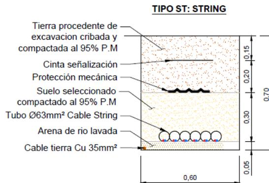
*Ilustración 6: Detalle de la zanja tipo string de BT*
