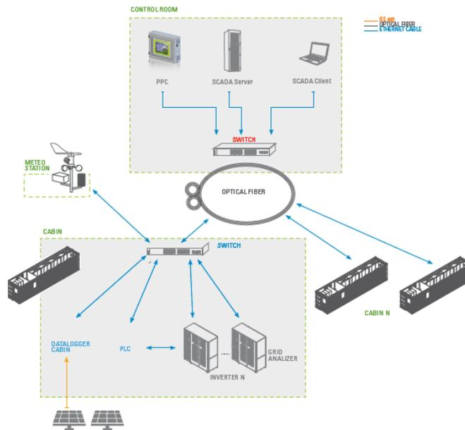
*Ilustración 10: Esquema del sistema de monitorización del módulo*
