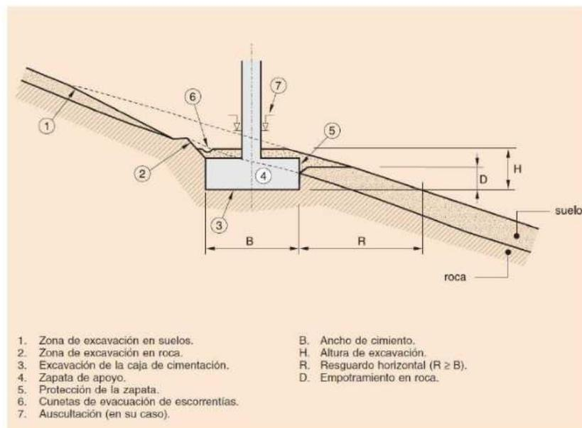
Figura 7. Esquema de cimentación superficial a media ladera tomado de la “Guía de cimentaciones en obras de carretera” del Ministerio de Fomento.
