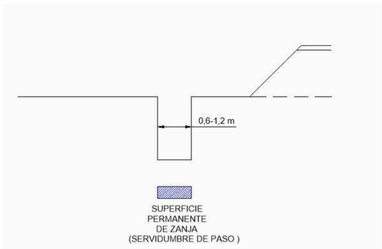
*Zanja subterránea (variable dependiendo del ancho de la zanja)*
