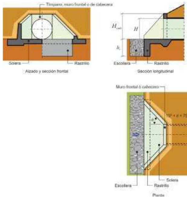
Figura 10 – Esquema de las embocaduras de una ODT
