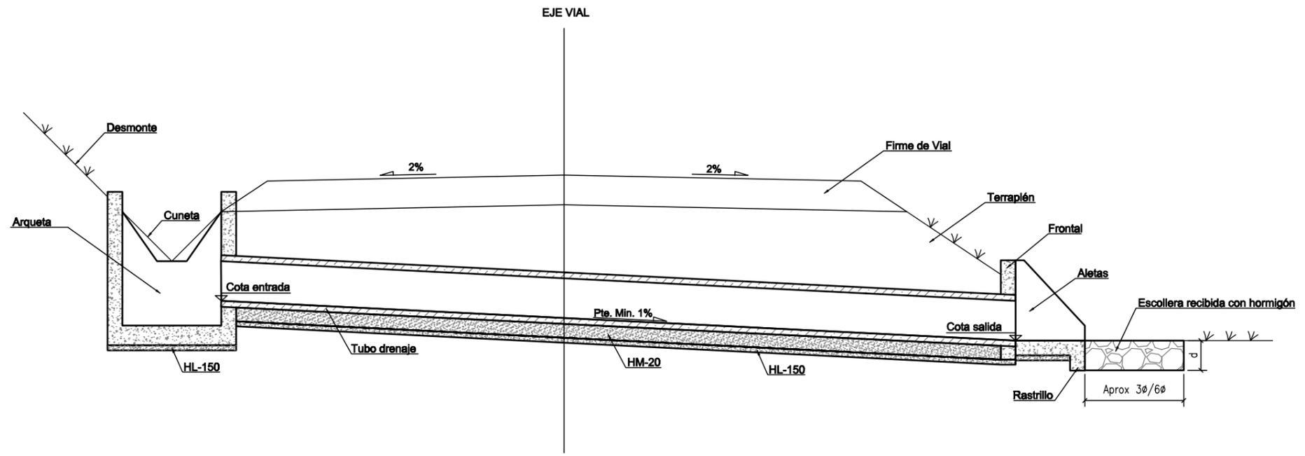
SECCIÓN TIPO OBRA DE DRENAJE TRANSVERSAL
