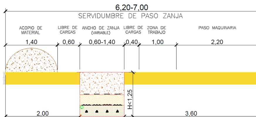
Ilustración 3: Sección transversal de detalle de servidumbre de zanja
