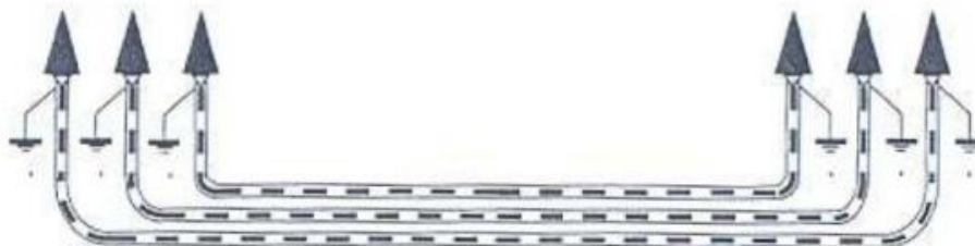
Figura 35.- Puesta a tierra de cubiertas metálicas.
