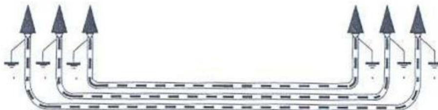
Figura 35.- Puesta a tierra de cubiertas metálicas.
