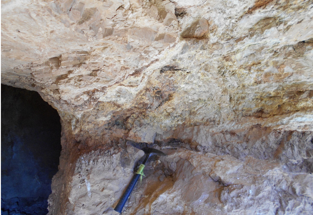
Foto 7. Labores de interior. Filones con ocras de Sb rellenando brechas en la mina La Abandonada.
