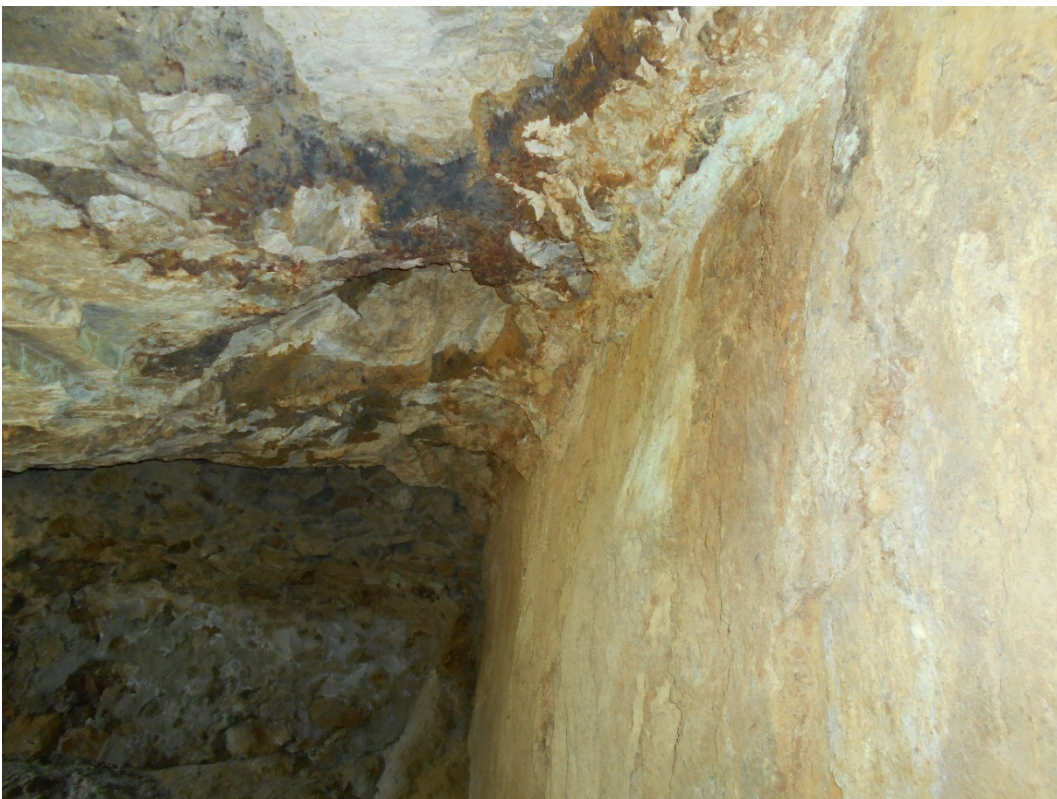
Foto 8. Labores de interior. Detalle de los filones brechoides con ocras de Sb. Mina La Abandonada.
