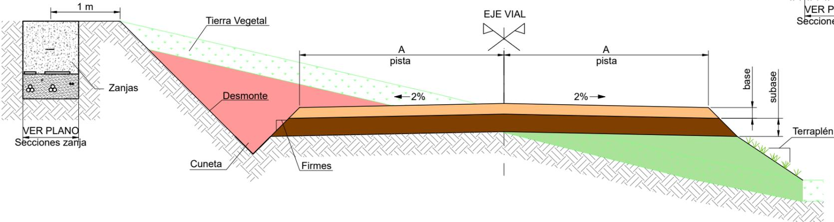
SECCION TIPO VIAL. DESMONTE Y TERRAPLÉN
