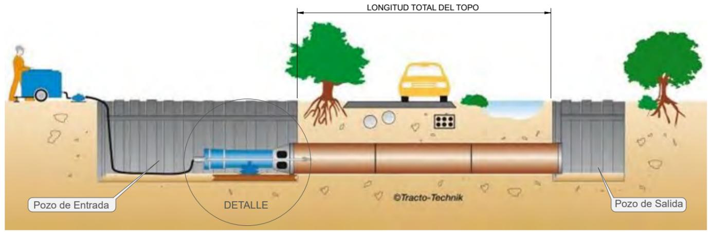
DETALLE DE FOSO DE ATAQUE PARA HINCA DE TUBO DE ACERO Ø < 800mm
