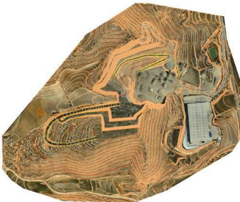
Figura 11. Fase 6: avance parcial del banco a cota 570
