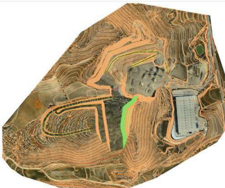
Figura 15. Fase 10: restauración de la zona este del banco a cota 570
