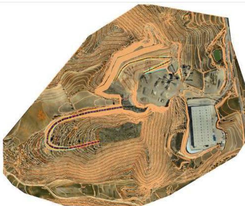
Figura 8. Fase 3: rebaje a cota 610
