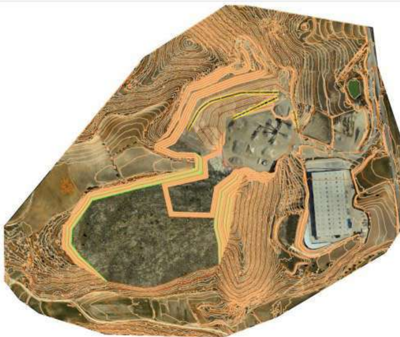
Figura 19. Fase 14: avance parcial del banco a cota 550
