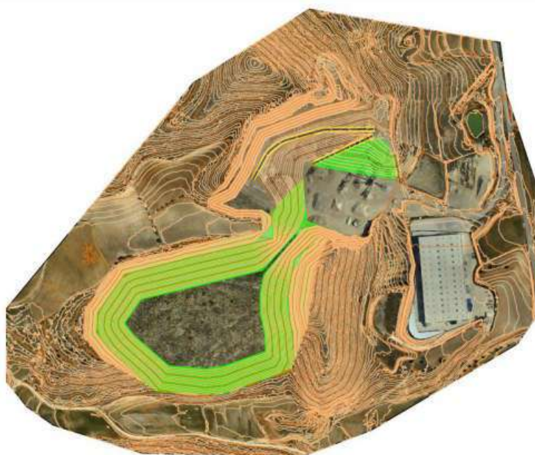
Figura 22. Fase 17: restauración total zona de planta de tratamiento
