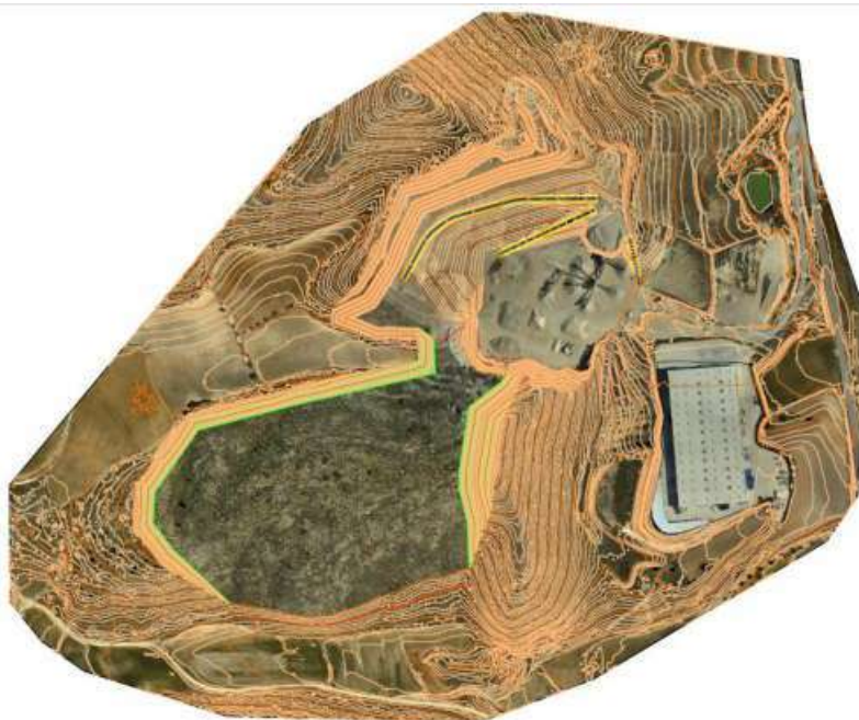
Figura 18. Fase 13: restauración de la zona oeste del banco a cota 570
