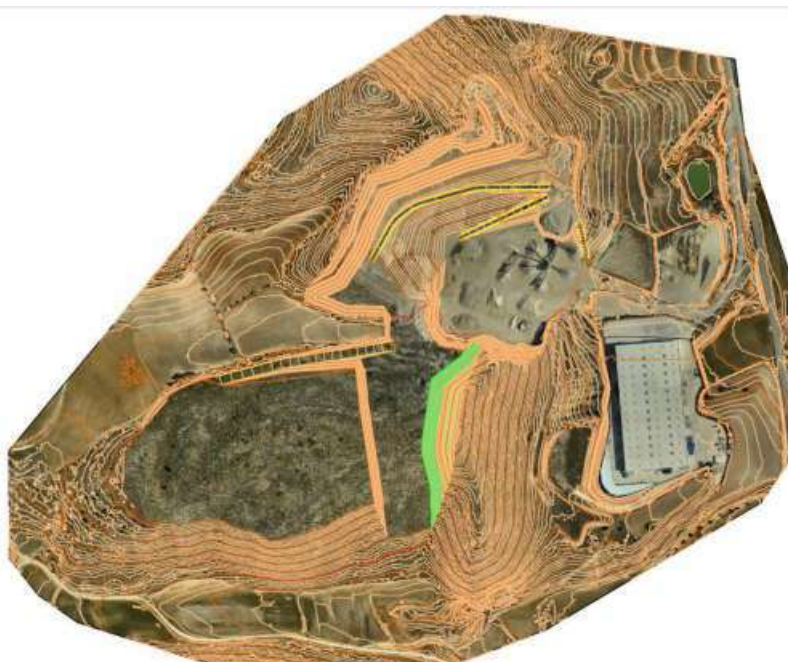
Figura 16. Fase 11: avance completo del banco a cota 590
