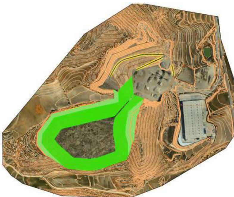
Figura 21. Fase 16: restauración total del banco a cota 550
