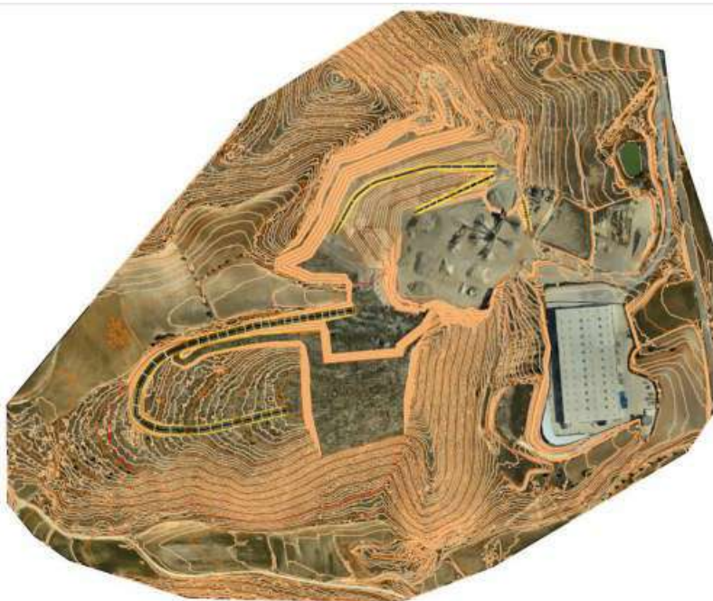
Figura 12. Fase 7: avance parcial del banco a cota 590
