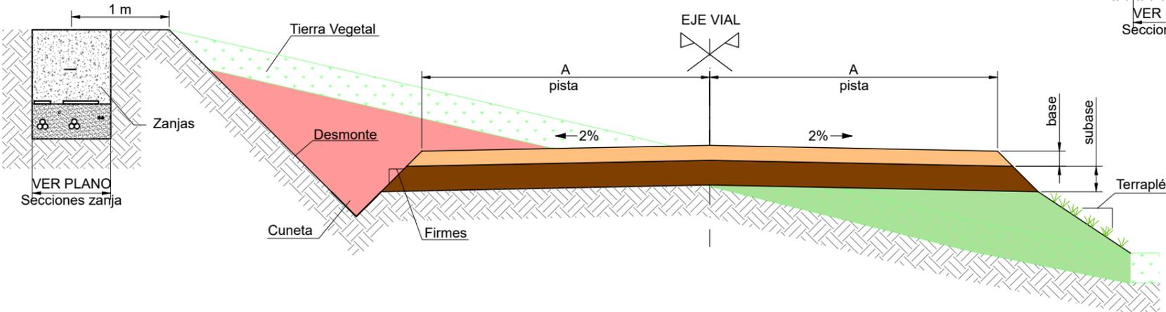
**SECCION TIPO VIAL. DESMONTE Y TERRAPLÉN**
