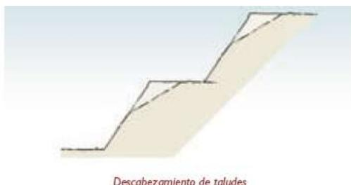
En explotaciones con varios frentes se pueden utilizar voladuras de descabezamiento que fragmentan la roca en la parte alta de los bancos dejándola depositada en las bermas horizontales, alcanzando ángulos de  $35$  a  $40^\circ$  entre los de reposo del material proyectado y los de la roca.
