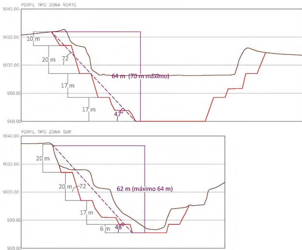
**Ilustración 43.** Perfiles tipo de explotación.
