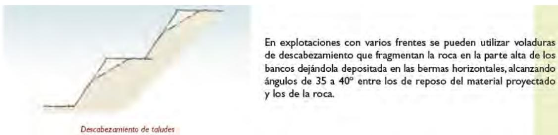
**Ilustración 49.** Descabezamiento de taludes.
