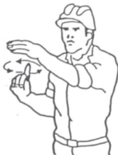
3 Levantar la carga lentamente
