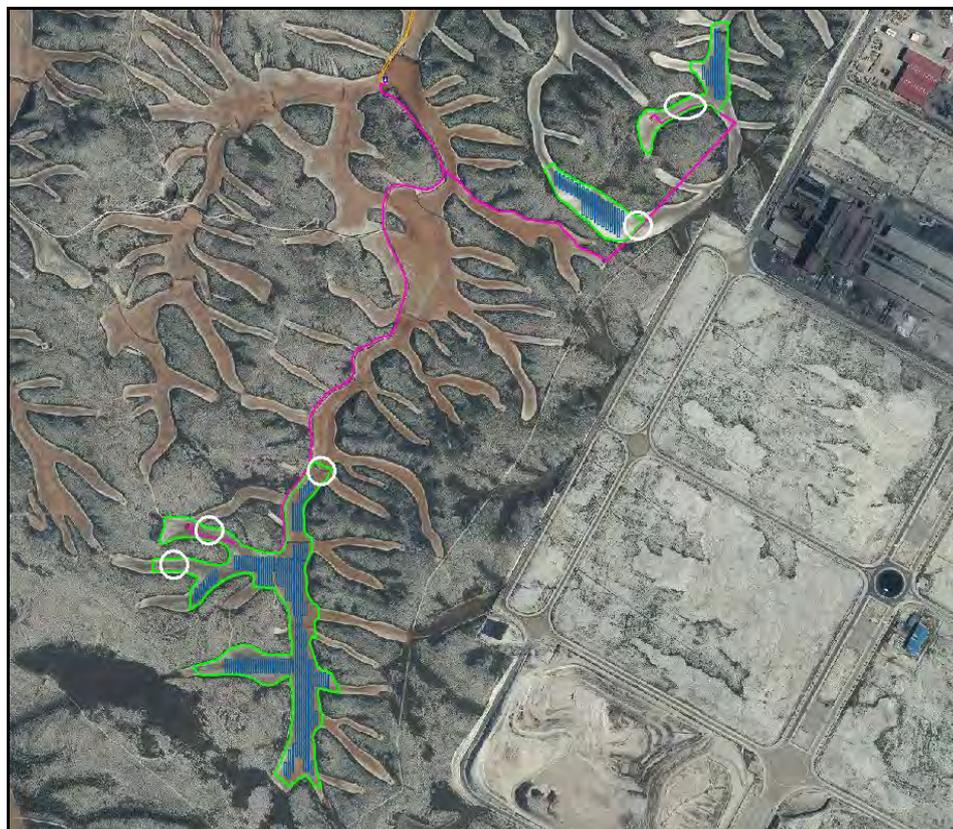
Marcadas con círculos blancos, las zonas previstas para almacenamiento temporal de residuos, aparcamiento de vehículos y maquinaria de obra. Fuente: Autorización Administrativa de Construcción Instalación Solar FV con conexión a Red PSFV El Descubrimiento 73, 4,54 MW. T.M. Zaragoza.
