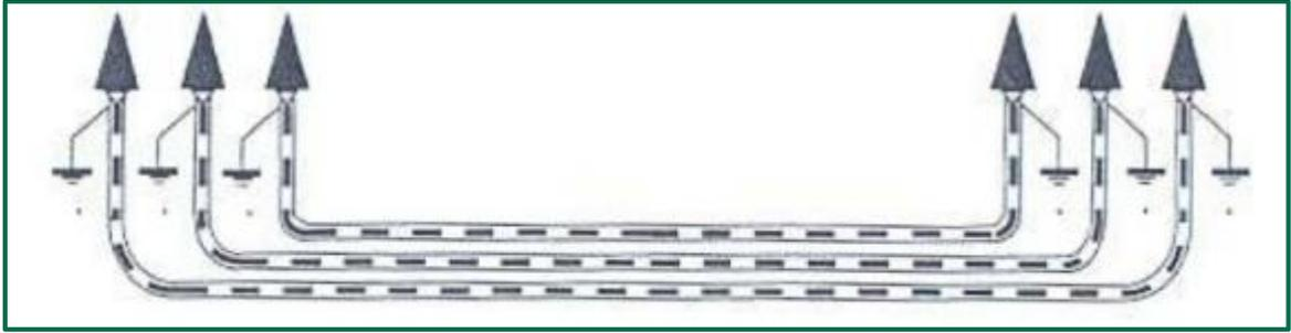
Figura 3: Puesta a tierra de cubiertas metálicas.
