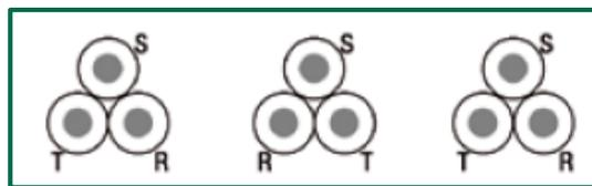
Figura 2: Colocación de cables en tresbolillo.
