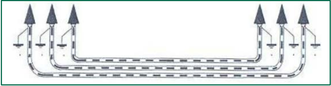
Figura 3: Puesta a tierra de cubiertas metálicas.
