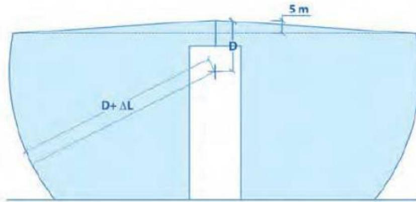
Bajo el plano horizontal situado 5 m por debajo de la punta, el volumen protegido es el de una esfera cuyo centro se sitúa en la vertical de la punta a una distancia  $D$  y cuyo radio es:  $R = D + \Delta L$ .
