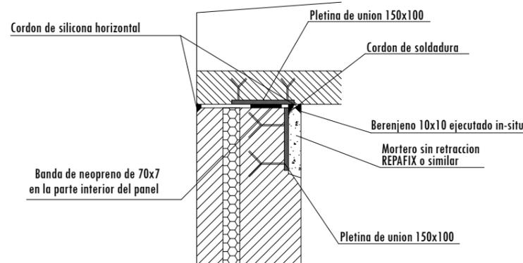
DETALLE UNION DE PANELES-CUBIERTA
