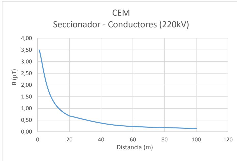
Ilustración 1- CEM seccionador
