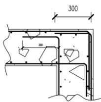
DETALLE DE ARMADURA EN ENCUENTRO DE MUROS EN L
