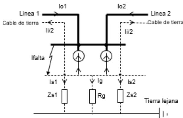
Es la parte de la corriente de defecto a tierra que pasa al terreno a través de la red de tierras y provoca la elevación de potencial en la misma.
