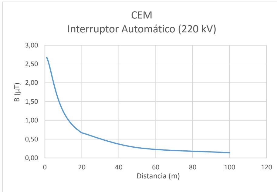
Ilustración 3- CEM interruptor automático
