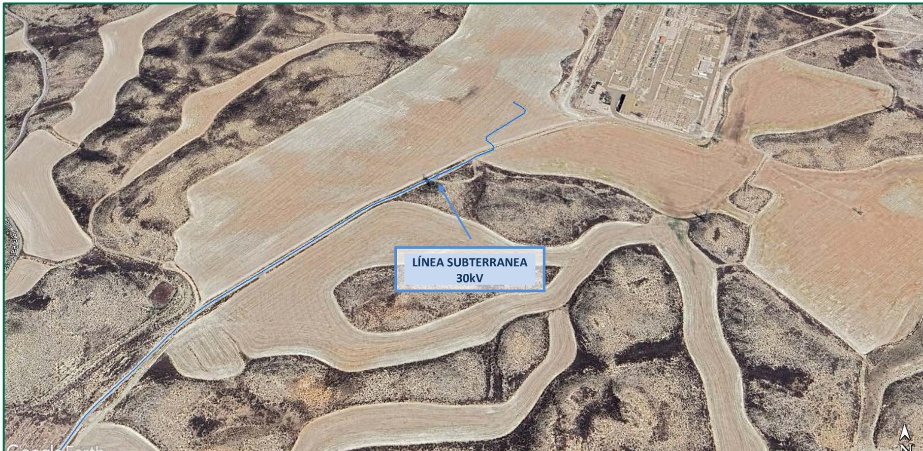
Recreación paisajística 9. Vista aérea del entorno más cercano al centro de seccionamiento y línea subterránea 30 kV. En detalle tramo final de la línea subterránea 30 kV y llegada a la SE Elevadora "Acampo Arréaz" 132/30 kV (objeto de otro proyecto).
