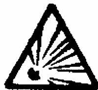
RIESGO DE EXPLOSION MATERIAL EXPLOSIVO
