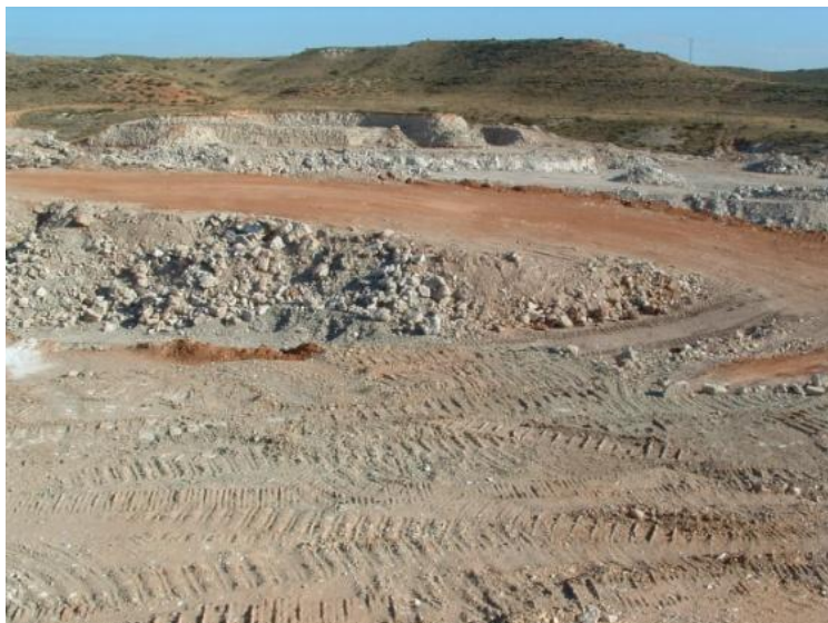
Figura 41. Frente de explotación realizado por la Titular en el denominado Frente 4 (punto 5 de toma de datos), donde puede apreciarse el nivel de alabastro N185-195 sobre la cota 185 m. aprox. Actualmente el frente está rehabilitado
