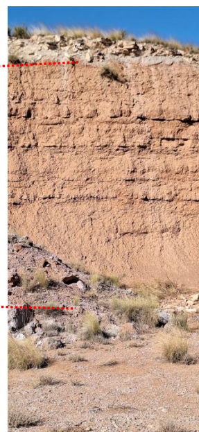
Figura 36. A la izquierda, corte estratigráfico levantado por el IGME en la zona noroeste de la Concesión "SOTENAL" del mismo Titular, a la derecha, corte en frente de explotación en el punto 8. Nivel de plaza entorno a la cota 190 m. y bancos de calizas coronando en frente entorno a la cota 200 m.
