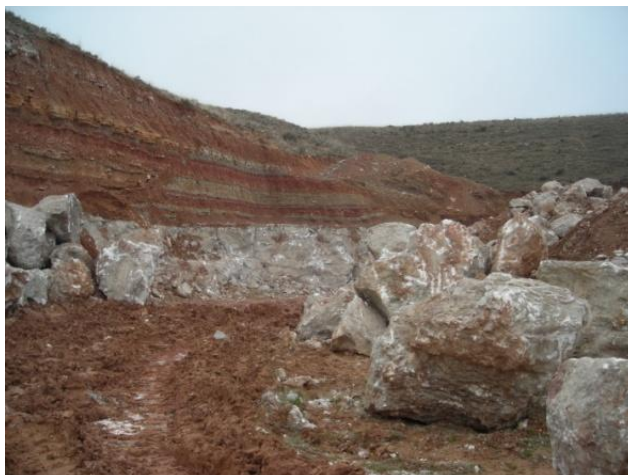
Figura 35. Frente de explotación realizado por la Titular en el denominado Frente 1 (punto 12 de toma de datos), donde puede apreciarse el nivel de alabastro N160-180 sobre la cota 180 m. aprox. actualmente el frente está rehabilitado
