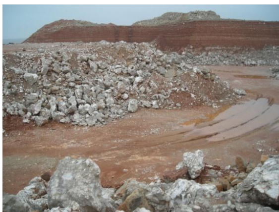
Figura 37. Frente de explotación realizado por la Titular en la denominada Zona 2 (punto 6 de toma de datos), donde puede apreciarse el nivel de alabastro N185-195 sobre la cota 200-205 m. aprox. Actualmente el frente está rehabilitado
