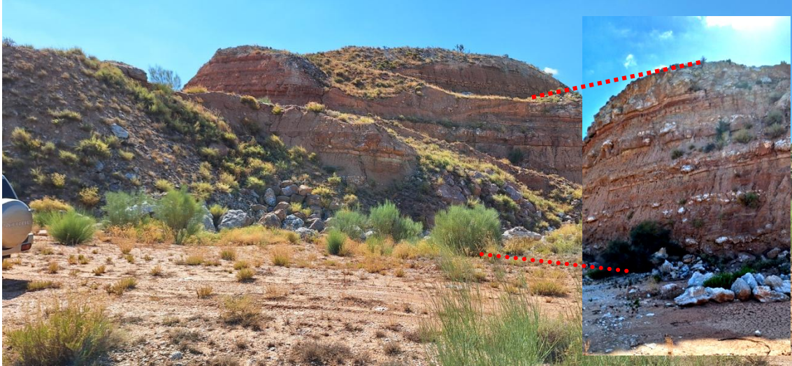
Figura 33. Niveles de alabastro N160-180 y N185-195 en frente del punto 12. El nivel de alabastro en plaza se sitúa en torno a la cota 180 m. La berma superior está emplazada alrededor de la cota 195 m. y los paquetes calizos coronan el corte, a partir de la 205 m. aprox.
