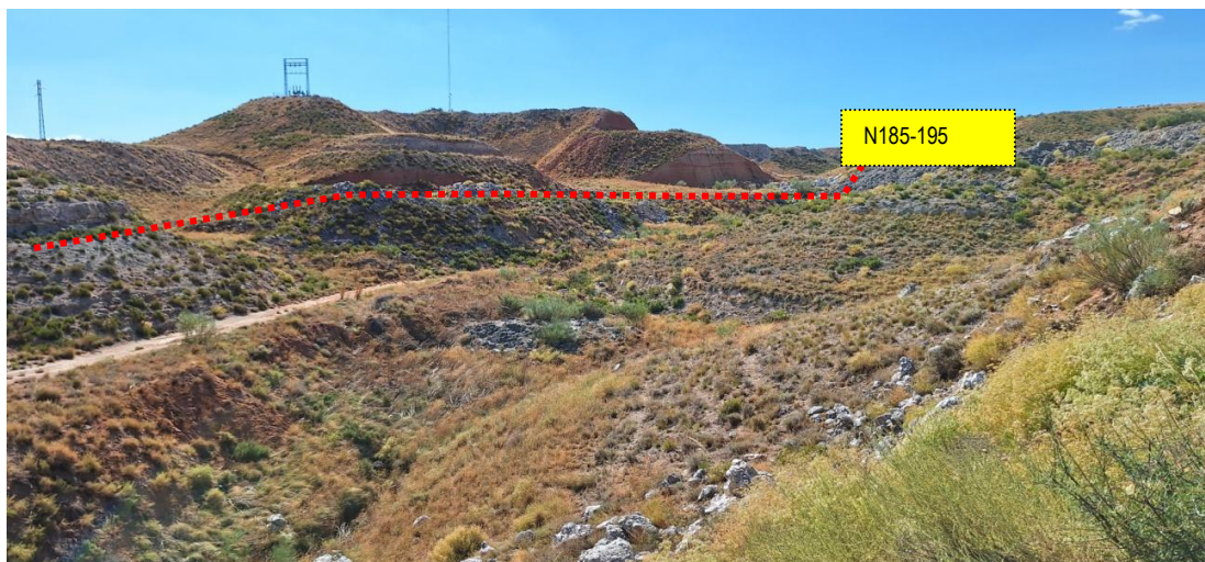
Figura 38. Continuidad del N185-195 apreciable en cortes y otras labores mineras antiguas (se ha marcado la cota 185 aprox.; fotografía desde el punto 14)
