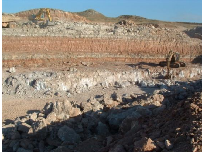
Figura 39. Frente de explotación realizado por la Titular en el denominado Frente 3 (punto 24 de toma de datos), donde puede apreciarse el nivel de alabastro N185-195 sobre la cota 185-190 m. aprox. Actualmente el frente está rehabilitado
