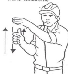
4 Levantar el aguilón o pluma lentamente
