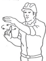
3 Levantar la carga lentamente
