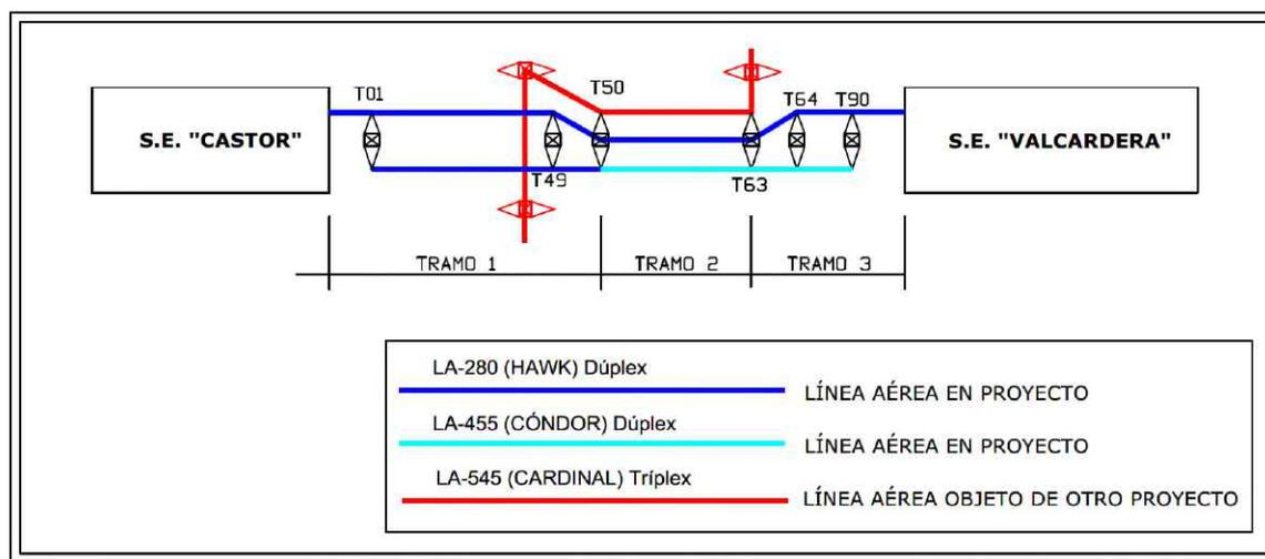
La línea objeto del presente Proyecto Modificado comparte apoyos, en el segundo tramo, con la Línea Aérea de Alta Tensión a 220 kV S.E.T "Tabuenca 1" 30/220 kV – S.E.T "Fréscano" 220/400 kV.
