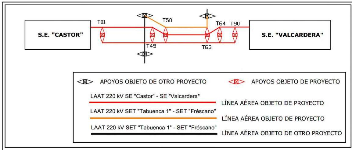
En la siguiente imagen se muestran los circuitos que conforman la línea eléctrica.
