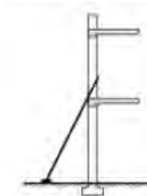
USAR ZAPATAS ANTIDESLIZANTES
