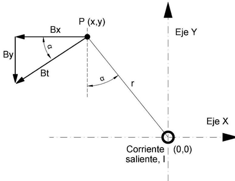
Se estudia la influencia del campo magnético fuera de los límites de la subestación, generado por el conjunto de los elementos de la instalación capaces de inducir un campo magnético relevante.
