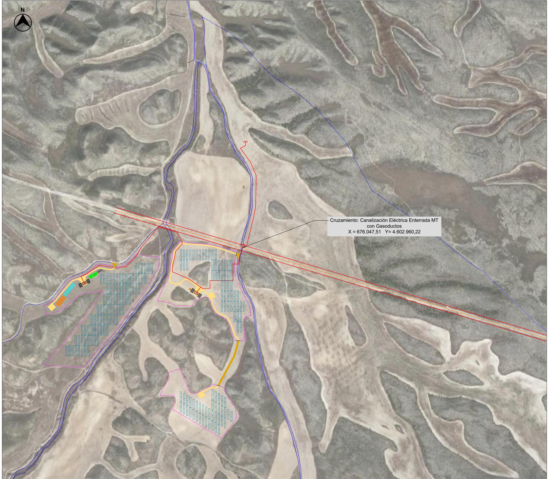
Cruzamiento: Canalización Eléctrica Enterrada MT con Gasoductos
