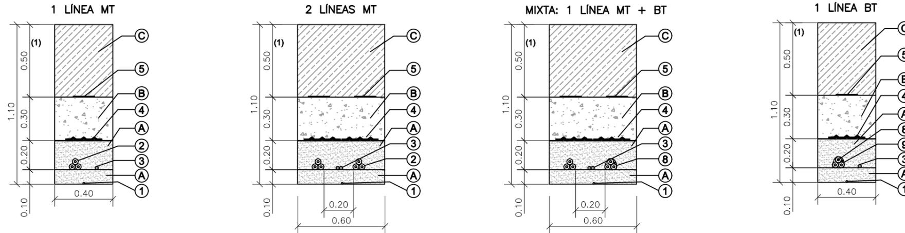
**DETALLE SECCIÓN ZANJA TIPO CRUCE VIAL Y CRUCE
