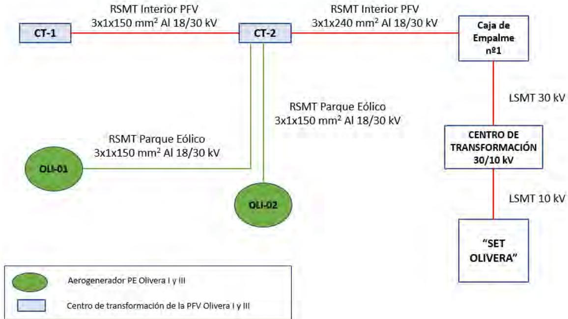
Ilustración 1. Diagrama de interconexión del PE "Olivera I y III" con la PFV "Olivera I y III" y su evacuación
