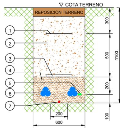
**SECCION ZANJA TIPO EN TIERRA
