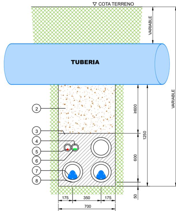
**SECCION ZANJA TIPO
