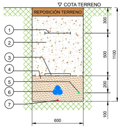
**SECCION ZANJA TIPO EN TIERRA
