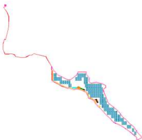
Figura 7: Lay-out de la Planta Solar
