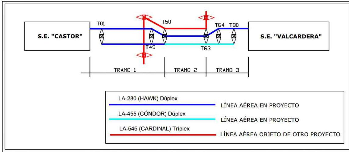
La línea objeto del presente Proyecto Modificado comparte apoyos, en el segundo tramo, con la Línea Aérea de Alta Tensión a 220 kV S.E.T "Tabuenca 1" 30/220 kV – S.E.T "Fréscano" 220/400 kV.
