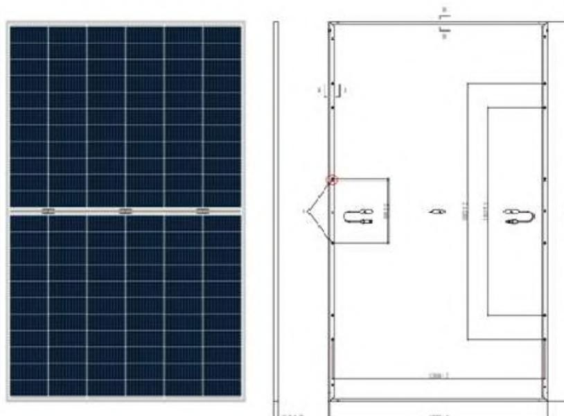
**Figura 10: Dimensiones del Módulo**
