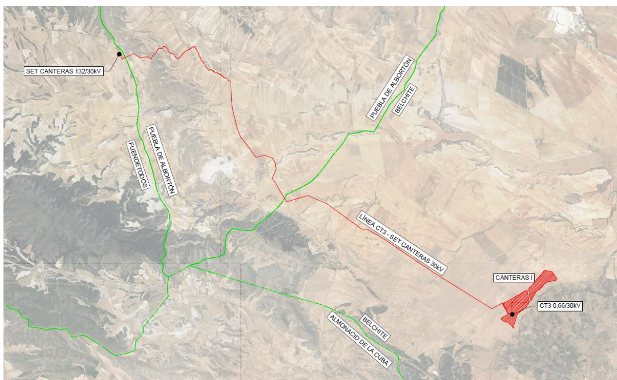
Ilustración 4: Trazado de línea de evacuación a SET
