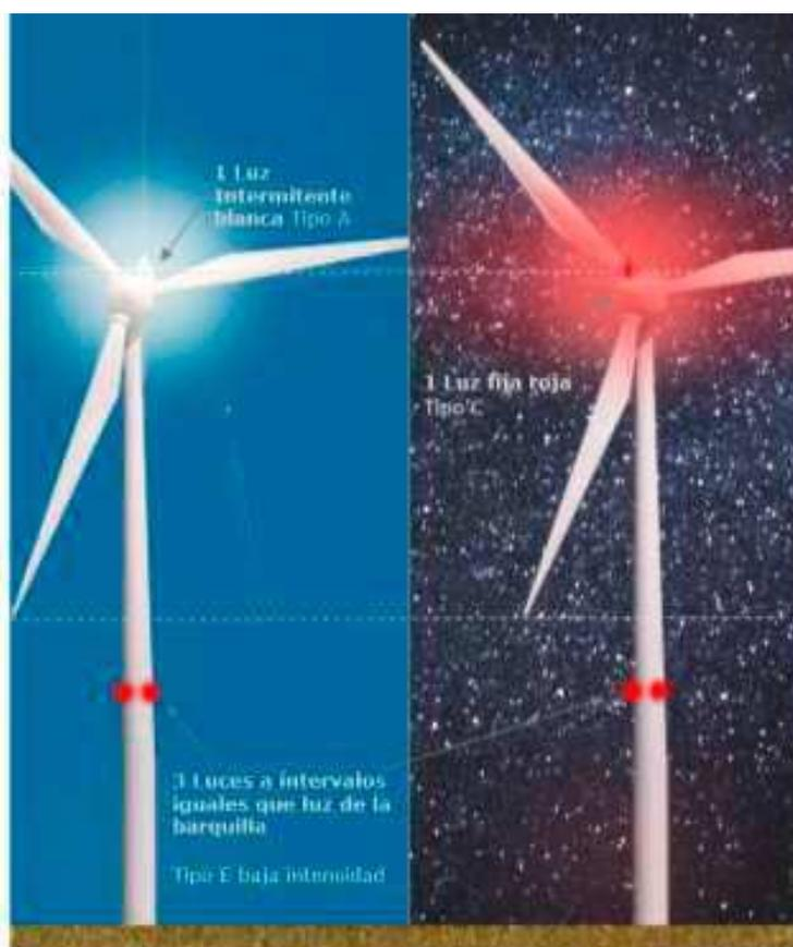
Estas balizas se situarán a una altura suficiente sobre el terreno, para que las palas en su movimiento no tapen las luces de obstáculo, y contarán con un mínimo de 3 luces de modo que se asegure la visibilidad desde todos los azimuts.
