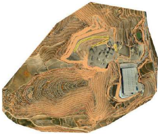
Figura 2. Fase 0: apertura del acceso a la cantera
