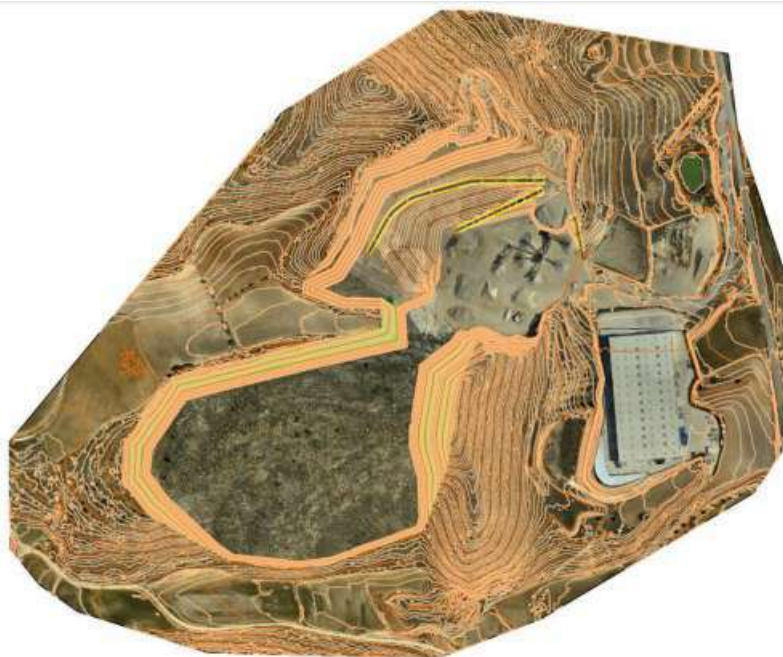
Figura 23. Fase 15: avance completo del banco a cota 550
