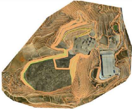
Figura 16. Fase 14: avance parcial del banco a cota 550
