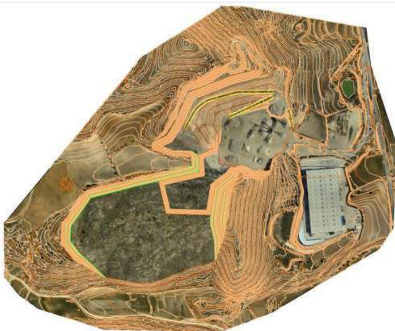
Figura 22. Fase 14: avance parcial del banco a cota 550
