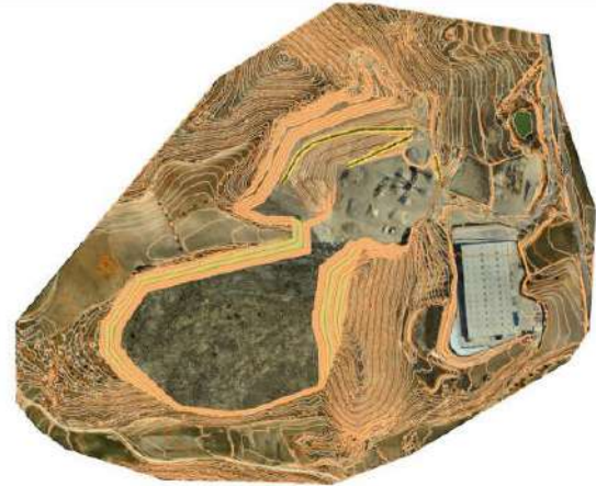
Figura 17. Fase 15: avance completo del banco a cota 550
