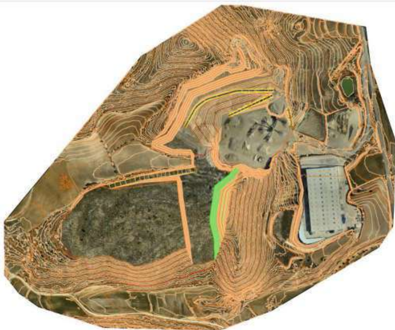
Figura 19. Fase 11: avance completo del banco a cota 590
