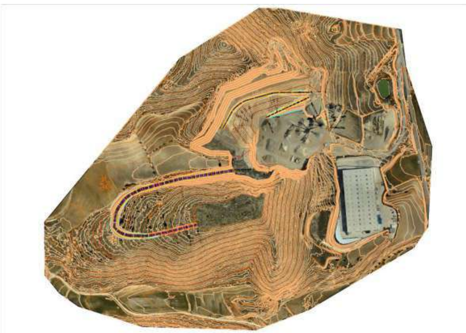
Figura 11. Fase 3: rebaje a cota 610
