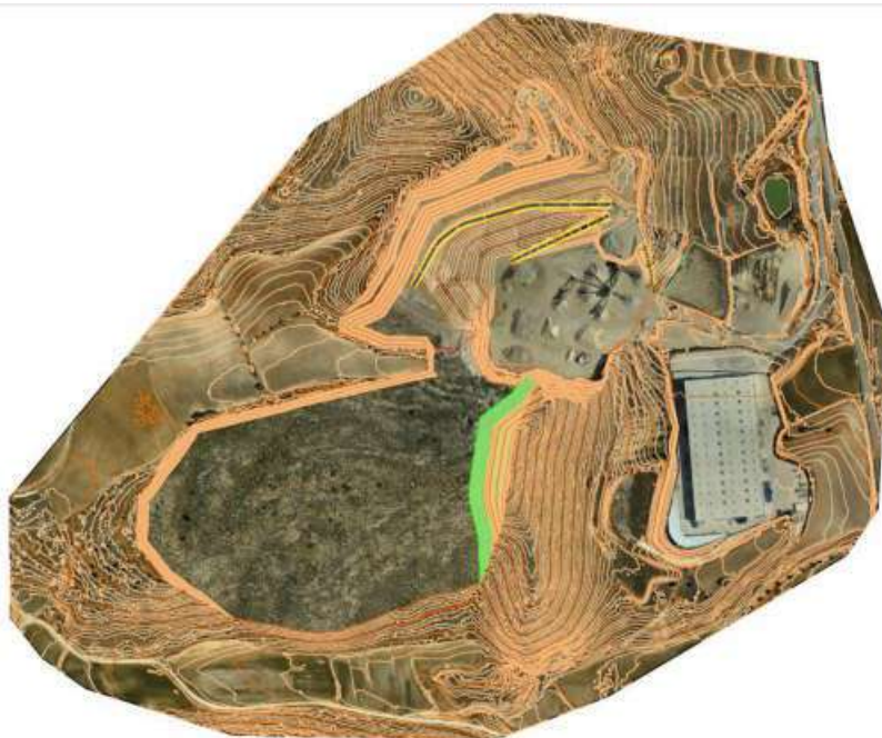
Figura 20. Fase 12: avance completo del banco a cota 570
