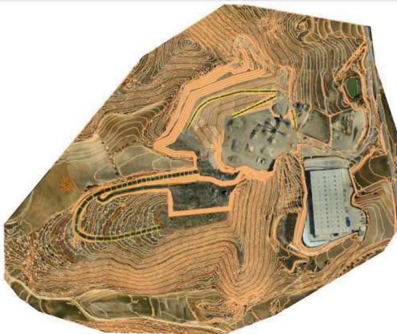
Figura 13. Fase 5: avance parcial del banco a cota 590
