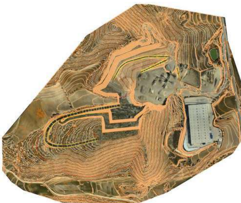
Figura 14. Fase 6: avance parcial del banco a cota 570
