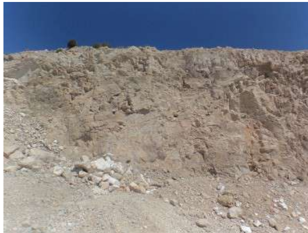
Figura 51. Parte superior del frente de explotación con las calizas en bancos decimétricos.
