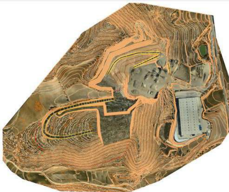
Figura 15. Fase 7: avance parcial del banco a cota 590
