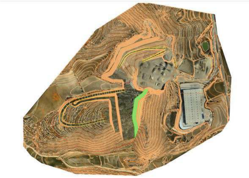
Figura 18. Fase 10: restauración de la zona este del banco a cota 570
