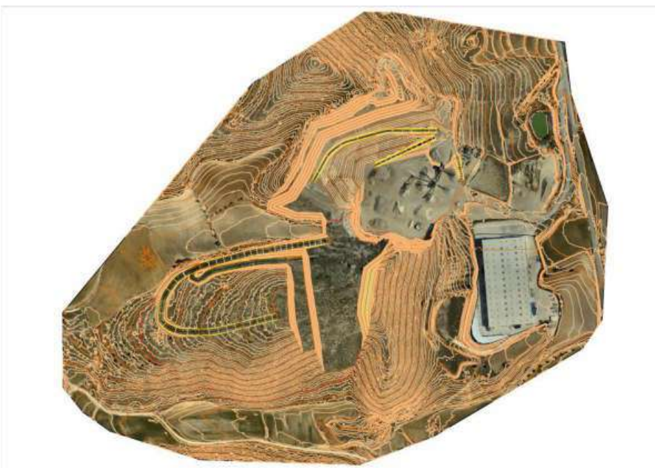
Figura 17. Fase 9: avance parcial del banco de cota 570
