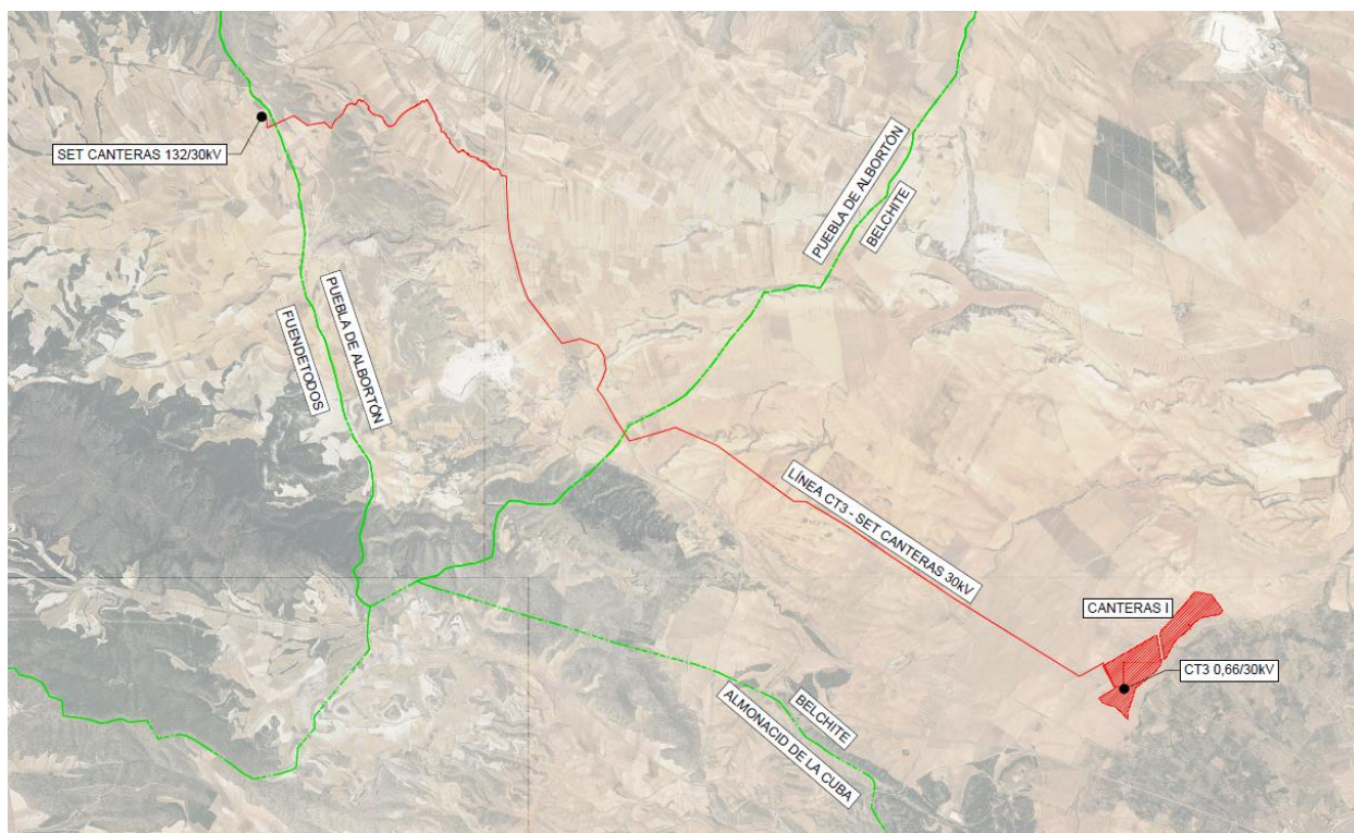
Ilustración 4: Trazado de línea de evacuación a SET
