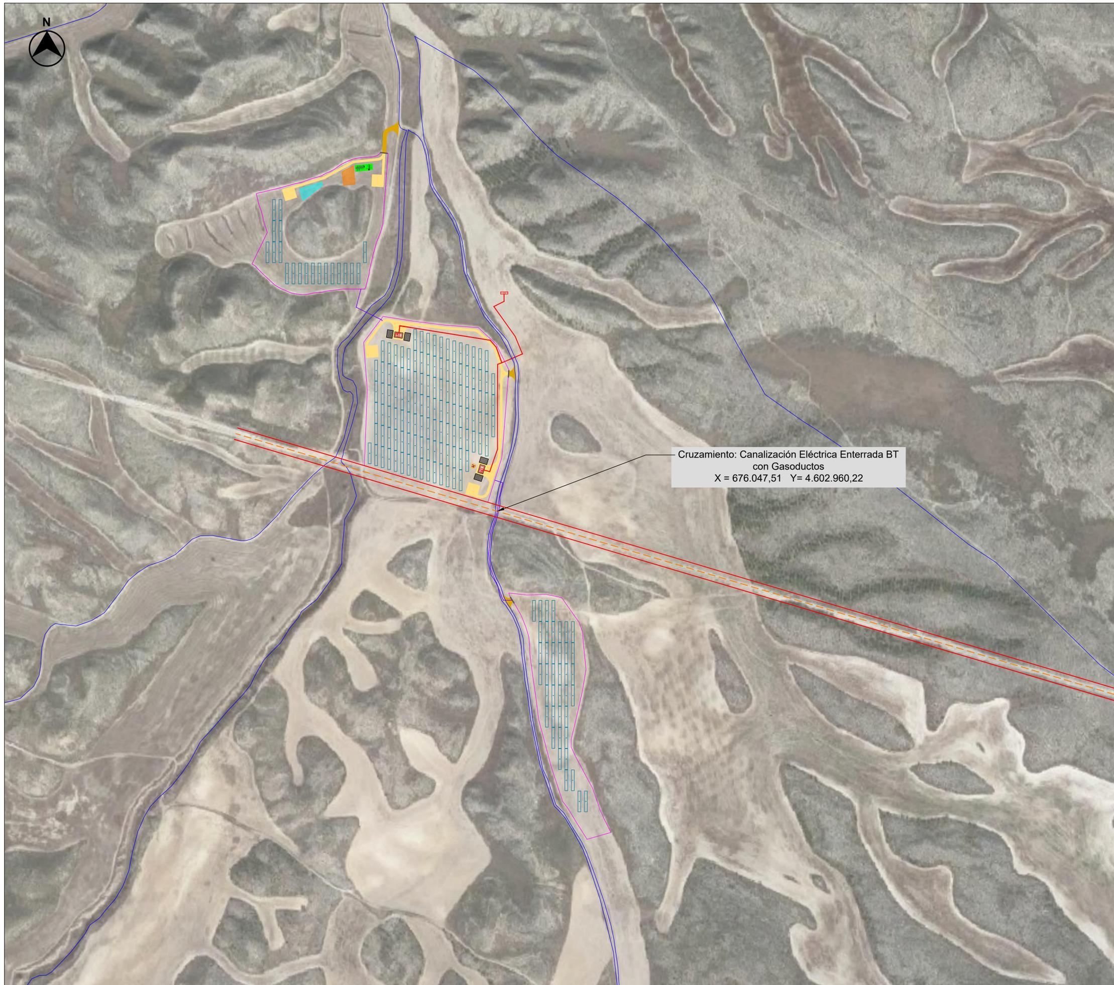
Cruzamiento: Canalización Eléctrica Enterrada BT con Gasoductos
