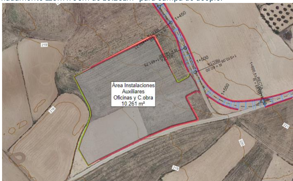
Imagen 4. Campa de Acopio y Oficinas.
