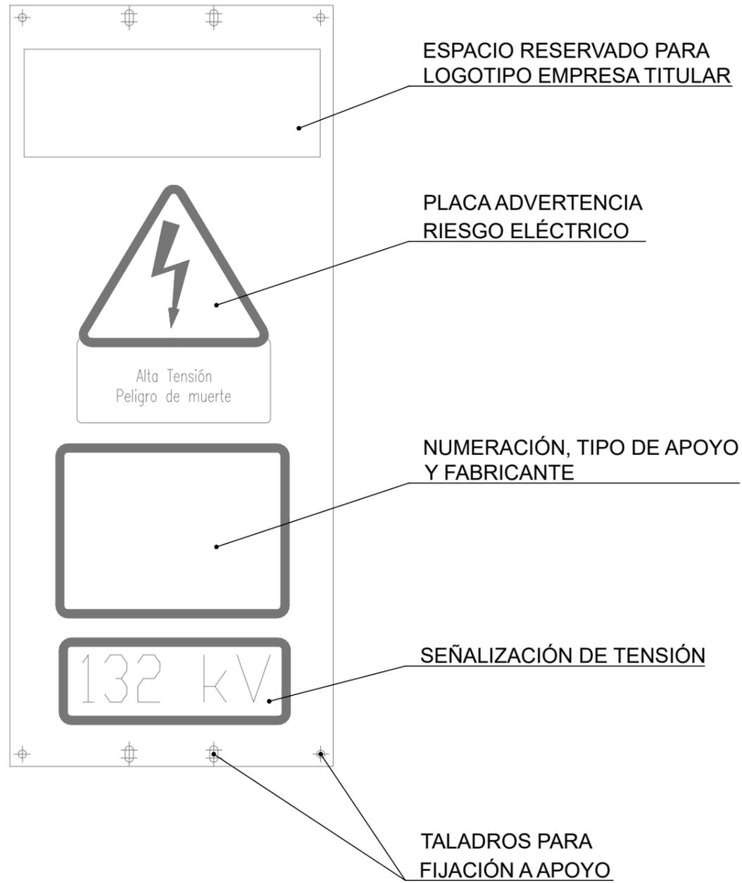
MATERIAL: CHAPA DE ACERO GALVANIZADO DE 1 mm DE ESPESOR
