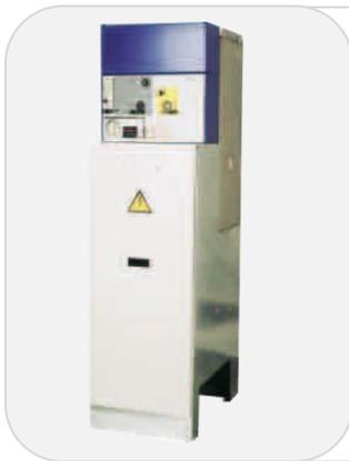
Se identifican con la letra 1V. Son utilizadas como celda de protección del transformador del aerogenerador. Están constituidas por una protección mediante interruptor automático tripolar en vacío. Además, también irán provistas de una bobina de disparo a emisión por temperatura del trafo, seccionador de puesta a tierra y alojamiento para las cabezas terminales de los puentes de unión de los interruptores seccionadores con el transformador.
