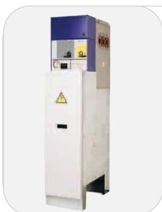
Se identifican con la letra 1L. Son utilizadas como celda de entrada de otros aerogeneradores del mismo circuito. Están constituidas por un interruptor-seccionador de tres posiciones y su función es la de independizar las partes de un circuito, de tal manera que no es necesario que todas las celdas de un mismo circuito estén operativas para que el circuito siga funcionando.
