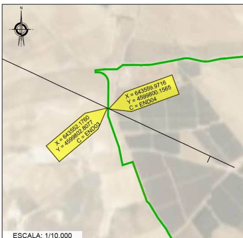
Imagen 26: Vista en detalle de los cruces de línea aérea de media tensión (36 kV) con la línea de evacuación de media tensión subterránea del parque eólico LANTANO
