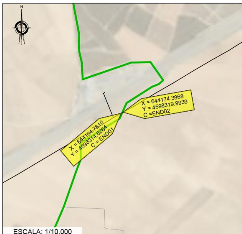
Imagen 25: Vista en detalle de los cruces de línea aérea de alta tensión (220 kV) con la línea de evacuación de media tensión subterránea del parque eólico LANTANO
