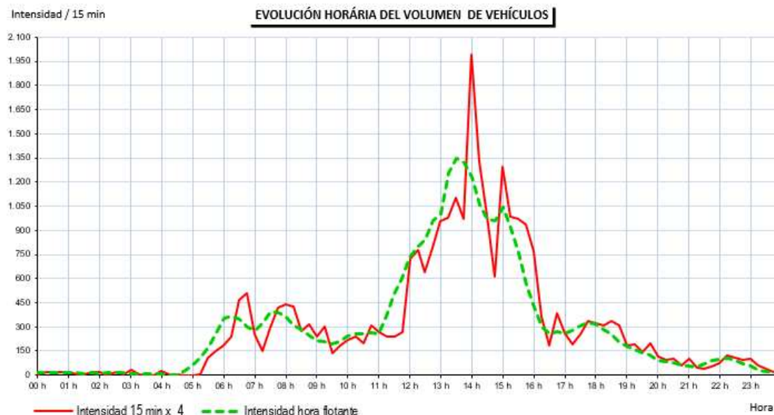
Ilustración 39: Aforos automáticos N-2 sentido C.H. Fuente: Doymo.
