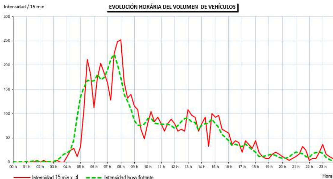
Ilustración 41: Aforos automáticos C.H sentido Autovía del Nordeste (A-2). Fuente: Doymo
