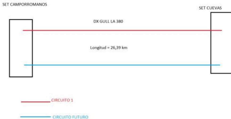
En el tramo aéreo de simple circuito, la línea se ha diseñado para doble circuito, aunque únicamente se tenderá un circuito en una primera fase de construcción, para equipar el segundo después.
