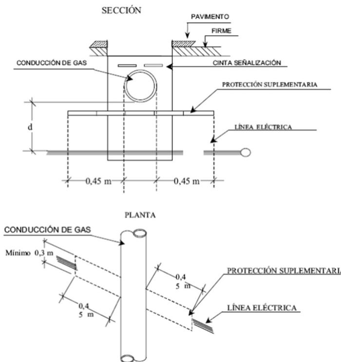
**Figura 34: Detalles de cruzamiento y conducciones (ITC-LAT 06).**
