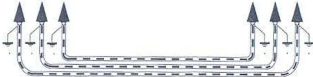
**Figura 32: Puesta a tierra de cubiertas metálicas.**
