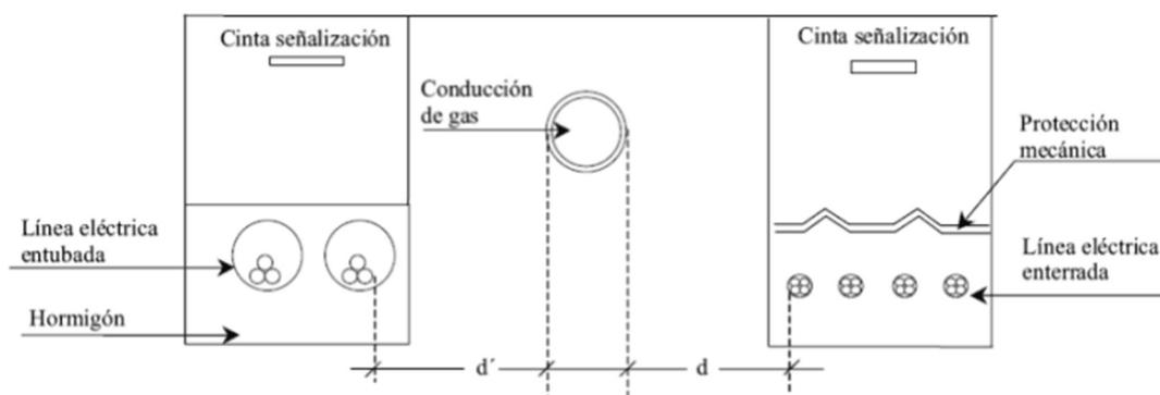
**Figura 36: Detalles de paralelismo y conducciones (ITC-LAT 06).**
