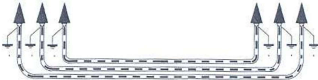
Figura 32: Puesta a tierra de cubiertas metálicas.
