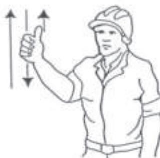
4 Levantar el aguilón o pluma lentamente
