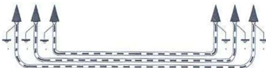
Figura 32: Puesta a tierra de cubiertas metálicas.
