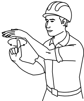
3 LEVANTAR LA CARGA LENTAMENTE
