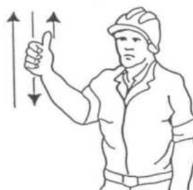
4 Levantar el aguilón o pluma lentamente
