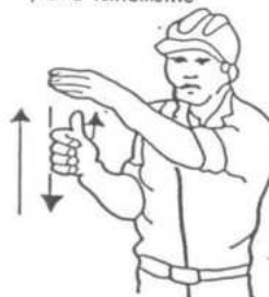
4 Levantar el aguilón o pluma lentamente
