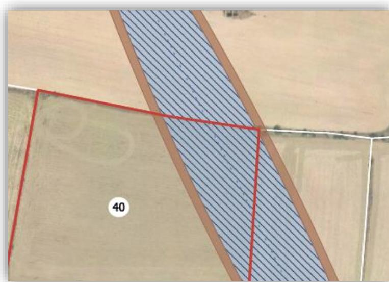
*Fig. 1 Imagen en planta del vuelo de línea eléctrica, en la que se aprecian la traza (línea punteada azul), la servidumbre de vuelo, considerada como servidumbre de paso para construcción, vigilancia y conservación (trama de líneas azules) y la de la zona de seguridad de líneas aéreas (franjas color marrón a ambos lados de la zona de servidumbre de vuelo)*
