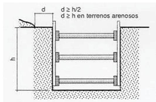
Cuando en los trabajos de excavación se empleen máquinas, camiones, etc. que supongan una sobrecarga, así como la existencia de tráfico rodado que transmita vibraciones que puedan dar lugar a desprendimientos de tierras en los taludes, se adoptarán las medidas oportunas de refuerzo de entibaciones y balizamiento y señalización de las diferentes zonas.
