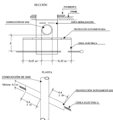
**Figura 10: Detalles de cruzamiento y conducciones (ITC-LAT 06).**
