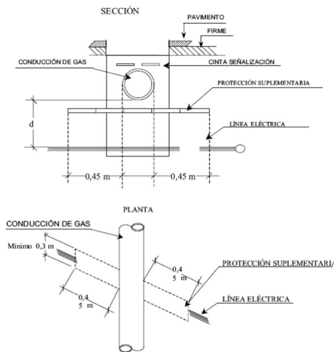
**Figura 17: Detalles de cruzamiento y conducciones (ITC-LAT 06).**
