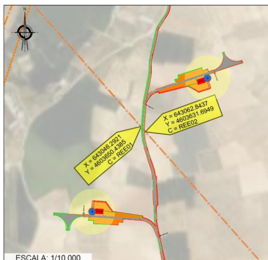
Imagen 22: vista en detalle de los cruces de línea aérea de alta tensión (220 kV) con la línea de evacuación de media tensión subterránea del parque eólico LUTECIO (1)
